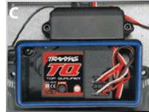
8. Installieren Sie die Abdeckung und ziehen Sie die beiden 3 x 8 mm Halbrundkopfschrauben fest an.
