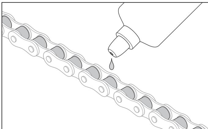
**TIPP:** Nachdem das mitgelieferte Kettenöl verbraucht ist, kann LOS77002 Kettenöl oder ein „trockenes“ Radkettenschmiermittel verwendet werden, um die Antriebskette zu schmieren.
