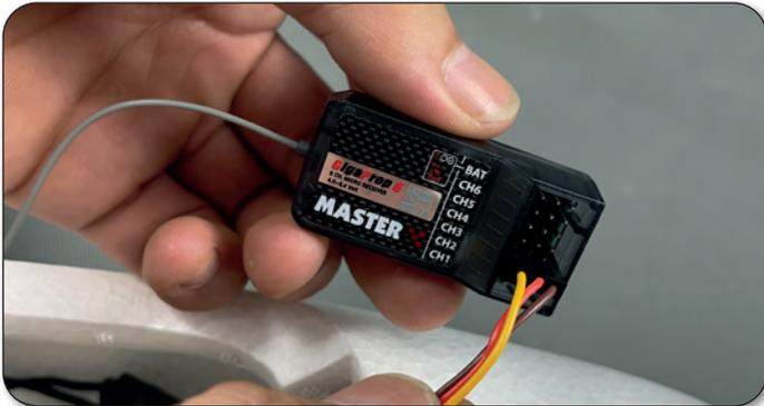
Abschließend den Empfänger mit Klettband im Modell befestigen. / Mount the receiver with velcro tape into the fuselage.
