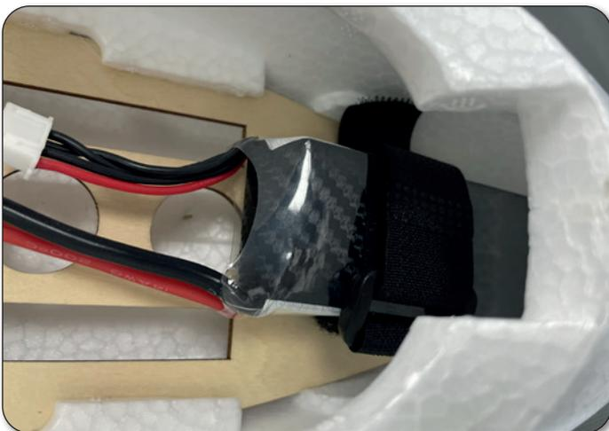
Akku mit Klettband sicher im Modell befestigen. Die endgültige Position des Akkus ergibt sich bei der Justierung des Schwerpunktes. / Use some velcro tape in order to secure the battery safely. The final position of the battery will be found when checking the CG.
