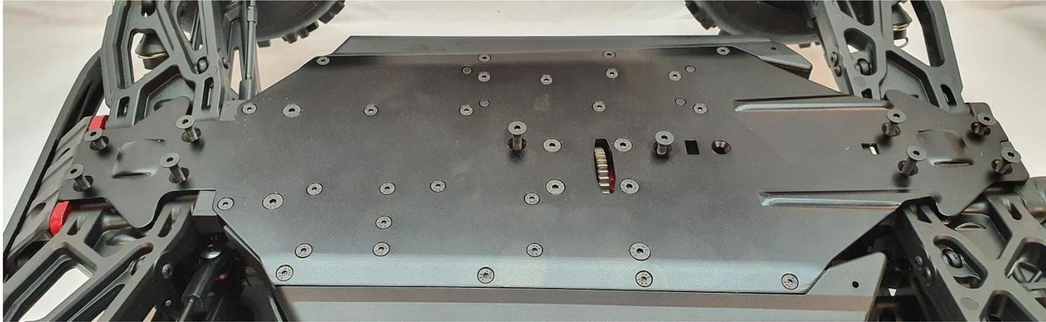
2. Montieren Sie die Bash Bar mit den beiliegenden, rostfreien Schrauben, indem Sie jede nur 2 Umdrehungen einschrauben. Danach einfach jede Schraube weitere 2 Umdrehungen einschrauben, dann zur nächsten usw. So wird ein Verkanten der Platte und somit ein nicht-planes Anbringen verhindert (Bild 2)
