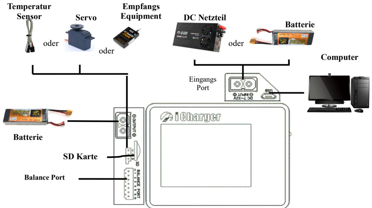
**Hinweis! : Sowohl der Eingang als auch der Ausgang nutzen XT60 Stecker. Es muss dringend darauf geachtet werden diese nicht zu vertauschen, sonst wird das Gerät beschädigt!**
