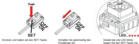
1. Stellen Sie sicher, dass alle Parameter (DR, Kurve, ATL) und die "ABS Bremsfunktion" am Gaskanal auf Default sind (entsprechend 0 oder 100%). Für Sender ohne LCD-Display, drehen Sie den Drehknopf bis zum Maximum, und "TRIM" auf 0. Bitte stellen Sie den entsprechenden Drehknopf auf neutrale Position. Für
