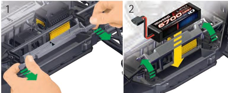
**Hinweis:** Die Batteriefacher passt auf den Traxxas 6.700 mAh 4s-Batterie (Teile Nr. 2890X). Wenn Sie andere LiPo-Batterien verwenden, sind zusätzliche Schaumstoffabstandsblöcke und Batterie-Pack-Abstandshalter benötigt, damit die Batterien korrekt eingesetzt werden können (siehe *Batterie-Tabelle*).
