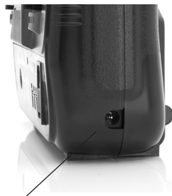
Ladebuchse für wiederaufladbare Akkus Charging plug for rechargeable transmitter batteries
