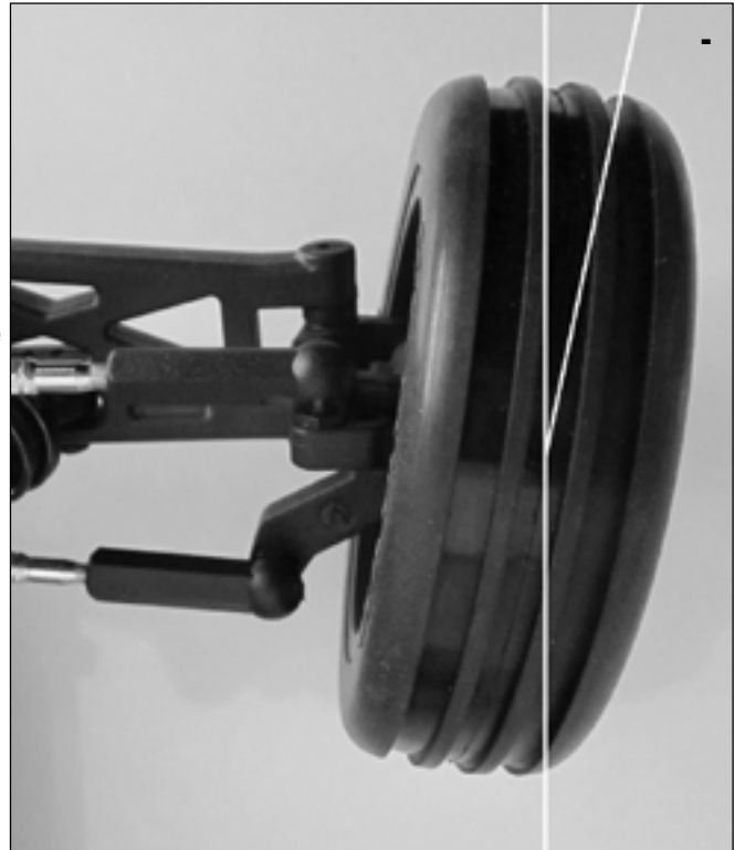
- Nachspur Toe Out Ouverture Convergencia negativa
