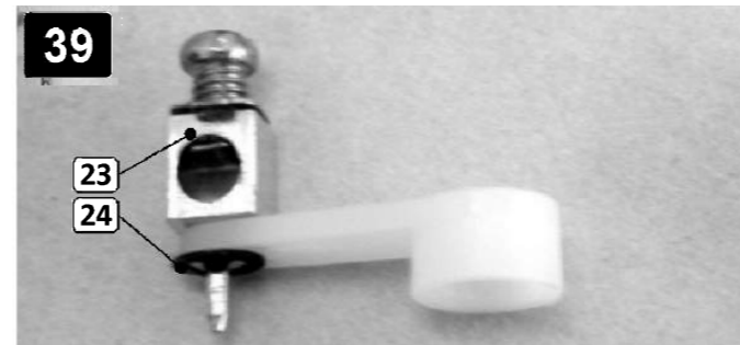
37 Táhlo SOP (28) připojte na páku SOP (18-4) a zajistěte jej plastovou podložkou (18-7). Podložku přilepte kapkou řídkého CA lepidla k drátěné koncovce (21). Connect rudder push rod (28) to the rudder horn (18-4). Put on the plastic former (18-7) into the "L" wire (21) and fix it with small drop of thin CA.
