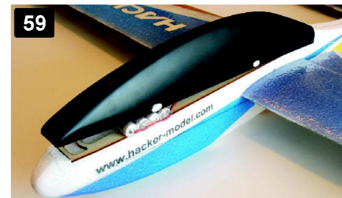
Pro vyvážení modelu vložte do trupu přijímač, nasadte kabínu a provizorně umístěte přijímačové baterie. To find right position of CG place receiver to the fuselage, attach canopy and put receiver's accu to the temporary place.
