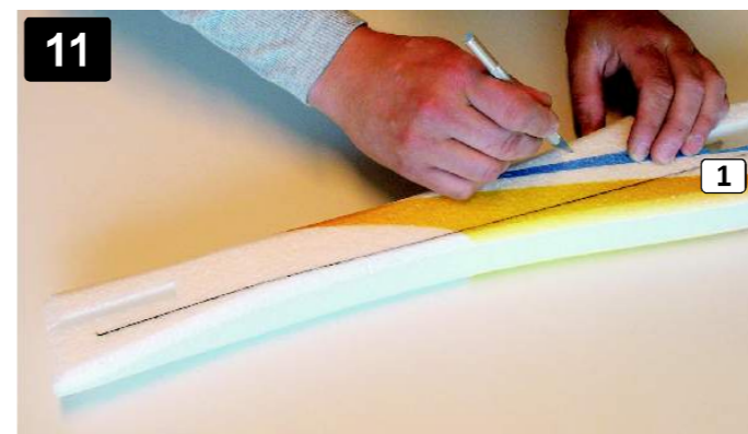
11 Na pravé straně trupu prořízněte drážku pro vedení lanovodu VOP (30). Hloubka 6mm. Cut the slot for the tube (30) on the right side of fuselage. Slot must be 6mm deep.
