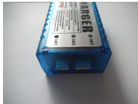
Raccordement de l'équilibreur 2S LIPO (GAUCHE)
