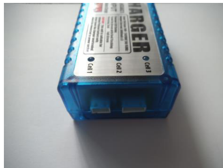
Balanceranschluß 2S LIPO ( LINKS)
