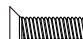
AX31120 (x8) M3x10mm Hex Socket Flat Head M3 x 10 mm Sechskant-Flachkopf Douille à six pans à tête plate M3 x 10 mm
