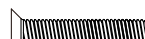
AXA148 (x11) M3x18mm Hex Socket Flat Head M3 x 18 mm Sechskant-Flachkopf Douille à six pans à tête plate M3 x 18 mm
