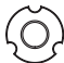
AX30132 (x4) Machined Shock Piston 7mm gefräste Stoßdämpferkolben 7 mm Piston amortisseurs usiné 7 mm
