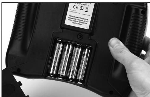
Entfernen Sie den Akkufachdeckel. Legen Sie die Batterien in das Batteriefach. Achten Sie auf die korrekte Polarität, die im Batteriefach markiert ist. Montieren Sie den Batteriefachdeckel und stellen Sie sicher, dass dieser fest sitzt.
