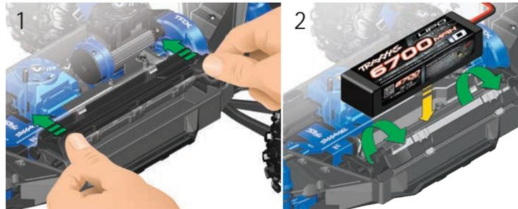
**Hinweis:** Das Batteriefach passt auf den Traxxas 6.700 mAh 4s-Batterie (Teile Nr. 2890X). Wenn Sie andere LiPo-Batterien verwenden, sind zusätzliche Schaumstoffabstandsblöcke und Batterie-Pack-Abstandshalter benötigt, damit die Batterien korrekt eingesetzt werden können (siehe *Batterie-Tabelle*).
