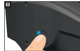
3. Drücken Sie die Taste am Traxxas-Link-Kabellos-Modul. Die blaue LED am Modul wird blinken (B).
