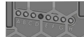
Wählen Sie die gewünschte Getriebeübersetzung aus dem Diagramm mit den Stiftpositionen aus. Tauschen Sie das Ritzel und das Zahnrad aus, wie benötigt. Wenn Sie den Motor wieder einbauen, platzieren Sie den Stift, abhängig von der gewählten Getriebeübersetzung, in seiner richtigen Position. Sichern
