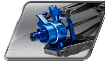
C-Radnaben und Lenkungsblöcke aus Aluminium
