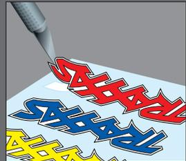
Zum Anbringen der Aufkleber setzen Sie eine Ecke an, halten das andere Ende hoch und streichen den Aufkleber dann mit ihrem Finger in Richtung des anderen Endes. So vermeiden Sie die Bildung von Luftblasen unter dem Aufkleber. Wenn Sie zwei Ecken gleichzeitig aufsetzen und dann versuchen, den Aufkleber zu glätten, werden Sie Lufteinschlüsse unter dem Aufkleber erhalten. Die Fotos auf der Verpackung zeigen typische Positionen für die Aufkleber.
