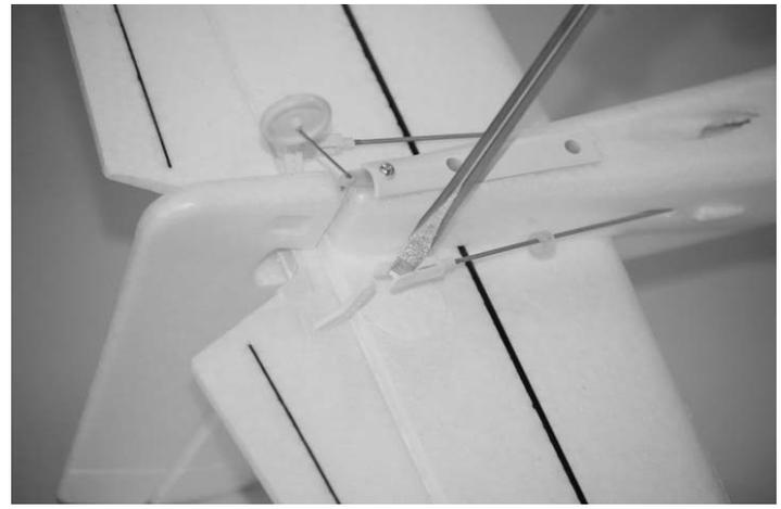
Nach dem Anschließen der Gabelköpfe an die Steuerhörner kontrollieren Sie das Seitenleitwerk, Höhenleitwerk und das Ruder von oben. Das Ruder sollte mit dem senkrechten Ruder ausgerichtet sein, wenn es richtig zentriert ist. Wenn das Ruder jedoch nach rechts oder links abgewinkelt ist, können Sie die Länge / Position der Anleung so einstellen, dass die Oberfläche mechanisch zentriert wird, während der Trimmhebel am Sender zentriert ist.
