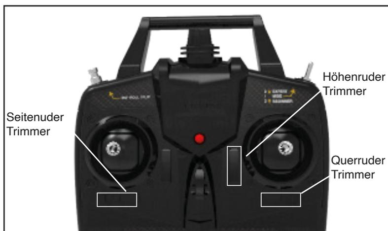
Mit den digitalen Trimmern lässt sich die Mittelstellung von Quer-, Seiten- oder Höhenruder einstellen. Jedes Mal, wenn ein Trimmer bewegt wird, ändert sich der Servoausgang um einen Winkel. Wenn der Trimmer gehalten wird, läuft der Ausgang in diese Richtung, bis der Trimmer losgelassen wird oder der Ausgang sein Ende erreicht. Wenn Sie einen kurzen "Piepton" hören, bedeutet dies, dass der Trimmer zentriert ist.
