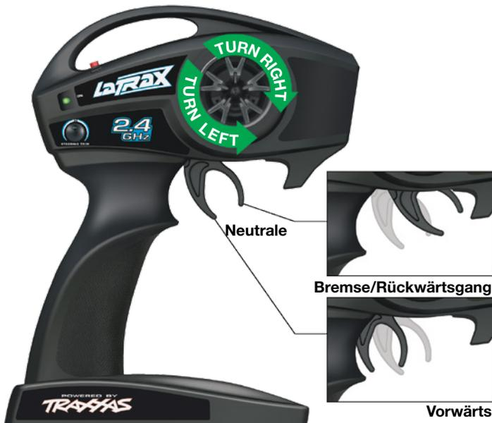
**i Rückwärtsfahren:** Drücken Sie während des Fahrens den Gashebel nach vorne, um zu bremsen. Wenn das Fahrzeug steht, bewegen Sie den Hebel wieder in die Nullposition. Bewegen Sie den Gashebel erneut nach vorne, um den Rückwärtsantrieb einzuschalten.
