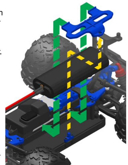
3. Setzen Sie den Batterieniederhalter wieder ein und stellen Sie dabei sicher, dass Sie die Batteriekabel nicht abklemmen. Sichern Sie den Batterieniederhalter mit den Karosserie-Clips. **Verbinden Sie den Batterie-Pack noch nicht mit dem elektronischen Geschwindigkeitsregler.**
