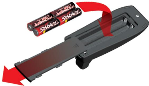
Wenn die Status-LED rot blinkt, sind eventuell die Batterien des Senders schwach, entladen oder nicht richtig installiert. Ersetzen Sie sie mit neuen oder frisch geladenen Batterien. Die Anzeigelampe zeigt nicht den Ladezustand der im Modell installierten Batterie an. Mehr Informationen über Sender, Statusanzeige und LED-Signale finden Sie auf Seite 11 im Abschnitt Fehlerbehebung.
