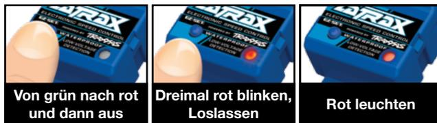
**i** Der zum Patent angemeldete Trainingsmodus (Profil 3) reduziert Vorwärts- und Rückwärtsfahren auf 50 %. Mit dem Trainingsmodus wird die Leistung des Modells reduziert, sodass Fahranfänger das Modell einfacher steuern können. Mit zunehmendem fahrerischen Können, wechseln Sie einfach in den Sport- oder Rennmodus für volle Leistung.
