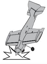
**HINWEIS:** Prüfen Sie nach jedem Aufschlag ob der Empfänger noch fest und sicher im Rumpf sitzt. Bitte achten Sie bei dem Auswechseln des Empfängers dass dieser in gleicher Einbaurichtung und Position wie der alte Empfänger ist, da sonst ein Schaden wahrscheinlich ist.
