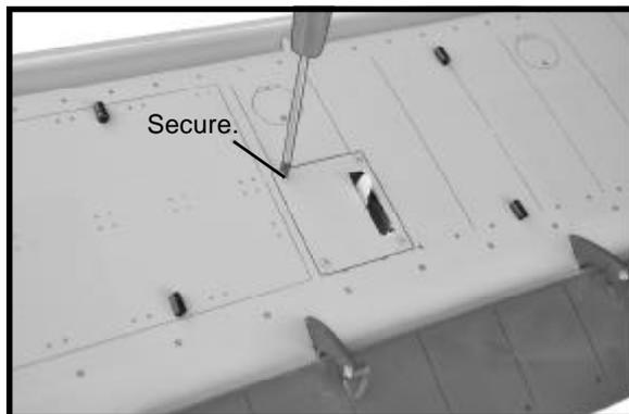
**2.INSTALLING THE FLAP CONTROL HORN.**
