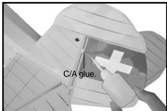
**RUDDER THE INSTALLATION.**
