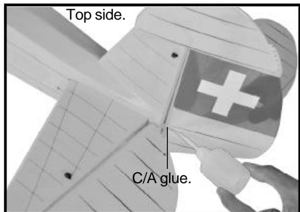
**RUDDER CONTROL HORN INSTALLATION.**
