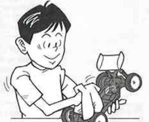
★Fahren Sie nicht an Stellen, wo Motor und Chassis überbeansprucht werden, wie etwa im Unterholz, bei Matsch und Regenwetter oder am Strand. Falls RC-Einheit, Motor oder die Batterien nass geworden sind, alles an einem trockenen, schattigen Platz sorgfältig reinigen und trocknen.
