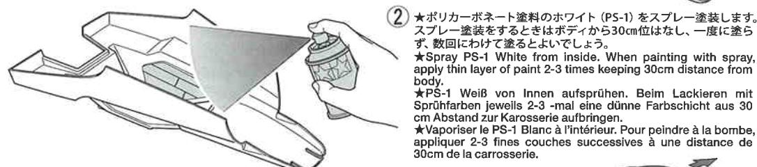
② ★ポリカーボネート塗料のホワイト(PS-1)をスプレー塗装します。スプレー塗装をするときはボディから30cm位はなし、一度に塗らず、数回にわけて塗るとよいでしょう。
