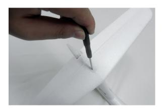
Schrauben Sie das Höhenleitwerk am Rumpf fest. Befestigen Sie die Servohörner per Schraube.
