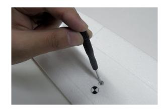
Befestigen Sie die Tragfläche mit den beiliegenden Schrauben am CFK-Tragflächenstab.
