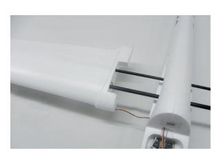
Anschließend werden die CFK-Flächenstäbe in die vorgesehenen Öffnungen im Rumpf eingeschoben. Die Tragfläche ist am Rumpf zu befestigen. Achten Sie darauf, das Servokabel nicht einzuklemmen.
