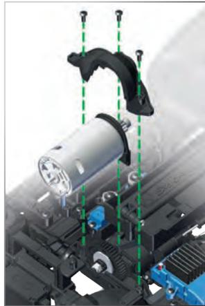
Um den Zahneingriff einzustellen, identifizieren Sie anhand der Tabelle links die Schraubenpositionen an der Motorplatte (A – H), die der gewählten Größe des Motorritzel (9-T – 22-T) und der Zahnradgröße (39-T oder 45-T) entsprechen. Lösen Sie die beiden Schrauben vom Motor/von der Motorplatte und setzen Sie sie an den entsprechenden Positionen wieder ein; setzen Sie den Motor/die Motorplatte wieder in das Chassis ein.
