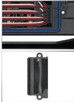
5. Installieren Sie die Kabelklemme und ziehen Sie die beiden 2,5 x 8 mm Schrauben fest an.
