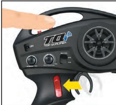
Mit dem Multifunktionsschalter am Sender können Sie die Geschwindigkeit exakt an Ihr eigenes Tempo anpassen. Drehen Sie den Schalter im Uhrzeigersinn, um die Geschwindigkeit zu erhöhen, oder gegen den Uhrzeigersinn, um die Geschwindigkeit zu verringern. Sie können bei eingeschalteter Geschwindigkeitsregelung beschleunigen und vorübergehend schneller fahren. Wenn Sie den Gashebel loslassen, wird das Fahrzeug die zuvor eingestellte Geschwindigkeit wieder aufnehmen (*Wiederaufnahmefunktion*).
