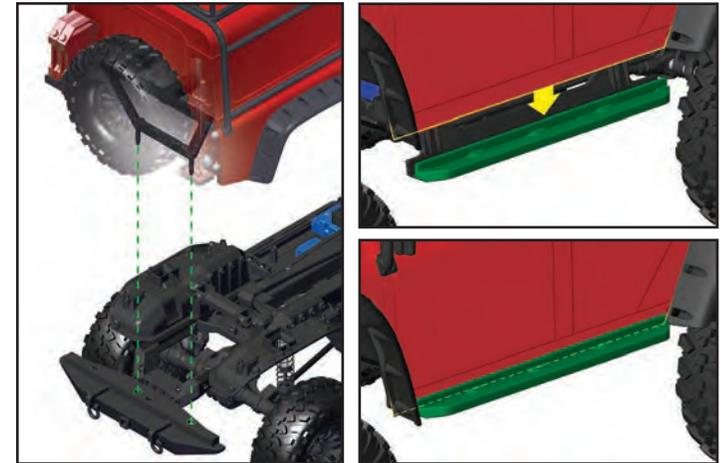
**Hinweis:** Um die einwandfreie Funktion des System zu gewährleisten, sollten Sie die Verriegelungen in der Karosserie und die Schlitze an den Kotflügeln regelmäßig überprüfen und reinigen. Wenn sich Schmutz und Dreck auf diesen Komponenten ansammeln, funktioniert das System nicht reibungslos.
