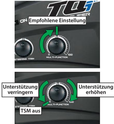
Drehen Sie den Schalter im Uhrzeigersinn, um die Hilfeleistung zu erhöhen, oder gegen den Uhrzeigersinn, um die Hilfeleistung zu verringern. Drehen Sie den Multifunktionsschalter bis zum Endpunkt gegen den Uhrzeigersinn, um TSM vollständig auszuschalten.
