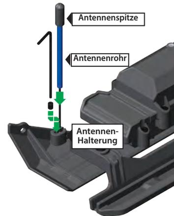
**!** Um einen Verlust des Funksignals oder eine Reduzierung der Reichweite zu vermeiden, bitte das schwarze Kabel nicht schneiden oder knicken, die Metallspitze nicht biegen oder abschneiden und das weiße Kabel am Ende der Metallspitze nicht biegen oder abschneiden.
