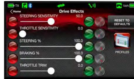
Tippen und schieben Sie, um die Lenkungsempfindlichkeit, Gaseinstellung, Bremskraftverteilung und mehr einzustellen!
