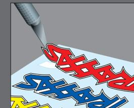
Zum Anbringen der Aufkleber setzen Sie eine Ecke an, halten das andere Ende hoch und streichen den Aufkleber dann mit ihrem Finger in Richtung des anderen Endes. So vermeiden Sie die Bildung von Luftblasen unter dem Aufkleber. Wenn Sie zwei Ecken gleichzeitig aufsetzen und dann versuchen, den Aufkleber zu glätten, werden Sie Luft einschließen unter dem Aufkleber erhalten. Die Fotos auf der Verpackung zeigen typische Positionen für die Aufkleber.
