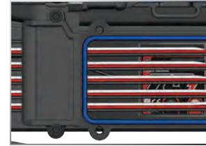
7. Stecken Sie die Kabel am Empfänger ein. Den Schaltplan finden Sie auf Seite 12.
