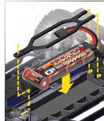
Setzen Sie die Batterie mit den Kabeln zur Rückseite des Modells ein. Setzen Sie die Laschen des Batterie-Niederhalters in die Schlitzte auf der Rückseite der Halterung und setzen Sie anschließend den Batterie-Niederhalter über der Abtrennung ein. Sichern Sie den Batterie-Niederhalter mit einem Karosserie-Clip im Loch der Abtrennung. Schließen Sie den Batterie-Pack noch nicht an.
