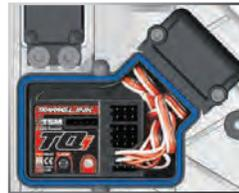
6. Installieren Sie den Empfänger mit doppelseitigem Klebeband in der Empfänger-Box.
