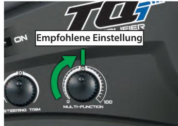
Drehen Sie den Schalter im Uhrzeigersinn, um die Hilfeleistung zu erhöhen, oder gegen den Uhrzeigersinn, um die Hilfeleistung zu verringern.
