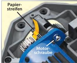
Zur Einstellung des Zahneingriffs lösen Sie die Motorschraube. Schneiden Sie einen dünnen Streifen Papier ab und legen Sie es zwischen die Zahnräder. Schieben Sie den Motor nach vorne, damit das Ritzel in das Zahnrad eingreift. Ziehen Sie die Schrauben des Motors fest und entfernen Sie den Streifen Papier. Der Papierstreifen sollte durch die Zahnräder bewegt werden können, ohne dass er klemmt.
