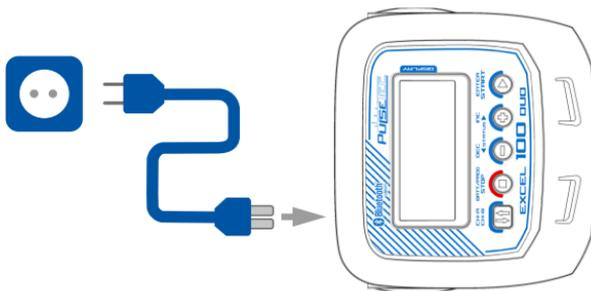
DC 11-18V= Anschluss (Autobatterie oder Netzteil).
