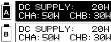
Kanal B und die Stromversorgung teilen sich den Rest der Leistung gleichmäßig auf. Wenn Sie beispielsweise die Stromversorgung auf 20W und Kanal A auf 50W einstellen, übernimmt Kanal B die Restleistung von 30W.
