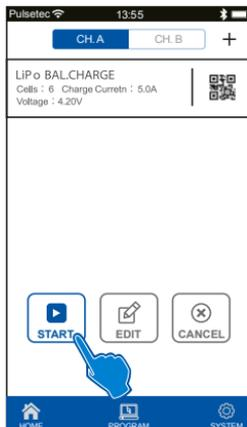
Mit "START" den Profilspeicher auswählen und den Vorgang starten. Mit "Edit" kann das Profil bearbeitet werden.
