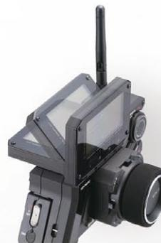
Das Herz und die Schaltzentrale der EX-1 mit Prozessor, RF-Modul und Display. Die Konsole kann zum Transport nach unten geklappt werden.
