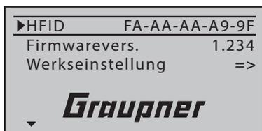
In diesem Menü werden senderspezifische Informationen angezeigt und es besteht die Möglichkeit, den Sender auf den Auslieferungszustand zurück zu setzen.
