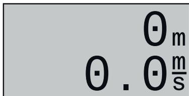
Dieses Display visualisiert die, von dem in das General-Air-Modul (Best.-Nr. 33611) integrierte Vario stammenden, Daten zur Höhe in m relativ zum Startort sowie die aktuelle Steig-/Sinkrate in m/s.
