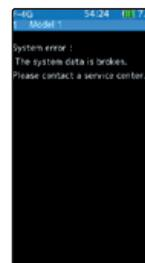
Wenn ein interner Fehler auftritt, erscheint die Meldung SYSTEM ERROR. Schalten Sie den Sender aus und erneut ein. Tritt der Fehler erneut auf, muss der Sender in den Service eingeschickt werden.
