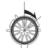
3. Lenkrad voll nach rechts drehen. Mit den Tasten + / - kann nun der Wert verändert werden, um den Lenkausschlag für rechts einzustellen.
