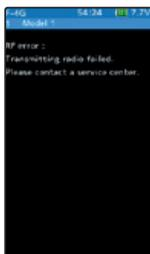
Wenn die Endstufe keine Sendersignale abstrahlt, erscheint die Meldung RF ERROR. Schalten Sie den Sender aus und erneut ein. Tritt der Fehler erneut auf, muss der Sender in den Service eingeschickt werden.
