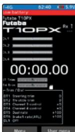
Wenn die Spannung im Sender die zulässige Grenze unterschreitet, ertönt ein akustischer Alarm und es erscheint im Display die Warnmeldung LOW BATTERY. Achten Sie unbedingt darauf, dass der korrekte Akkutyp im Sender eingestellt ist!
