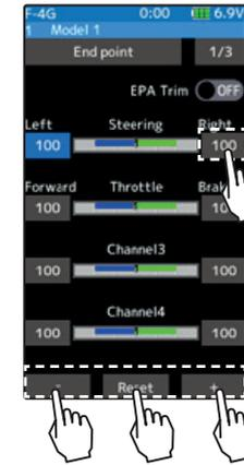
Beispiel: Um den rechten Lenkungsausschlag im End Point Menü zu ändern, tippen Sie bei Steering auf Right. Mit den Tasten + / - kann nun der Wert verändert werden. Werden die Tasten + / - permanent gehalten, verändert sich der Wert fortlaufend. Tippen Sie auf Reset, um zum Anfangswert zurückzukehren.
