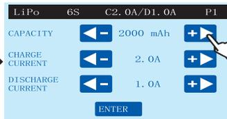
Wählen Sie mit den Pfeiltasten die gewünschten Werte für Kapazität, Lade- & Entladestrom. Bestätigen Sie mit „ENTER“ die gewünschten Werte. Wenn Sie einen Akku mit 900mAh laden möchten, beträgt der Ladestrom 1C, also 0,9A. Wenn der Akku für höhere Ladeströme zugelassen ist, kann der Ladestrom entsprechend erhöht werden.
