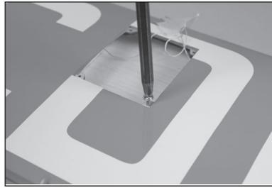
23. Ein bis zwei Tropfen dünnen CA-Klebstoff in jedes Loch auftragen, um das umgebende Holz zu härten. Der CA-Klebstoff muss vor dem Fortfahren vollständig ausgehärtet sein.
