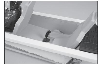
128. Die hintere Instrumententafel mithilfe von mittelstarkem CA-Klebstoff im Cockpit sichern.
