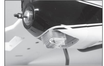
70. Die Motorhaube zurückschieben, bis sie die Vorderkante der Tragfläche leicht berührt.
