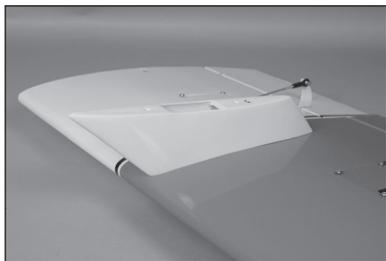
156. Den äußeren Abwurf-Pylon mithilfe von zwei M4 x 15 mm Innensechskantschrauben am Pylon befestigen.
