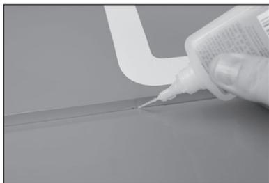
18. Nachdem der CA-Klebstoff vollständig ausgehärtet ist, vorsichtig an Stabilisator und Höhenruder ziehen, um sicherzustellen, dass die Aufhängungen sicher verklebt sind.
