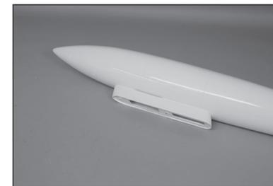
154. Der Kraftstofftank-Pylon wird nun mithilfe von zwei M4 x 20 mm Rundkopfschrauben und zwei 4 mm Unterlegscheiben am Rumpf befestigt.
