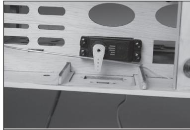
83. Den Gasservo-Steckverbinder im Gas-Servoarm montieren. Einen Tropfen Kanzelkleber auf die M2-Mutter geben und diese dann auf der Unterseite des Arms montieren, um den Steckverbinder zu fixieren.
