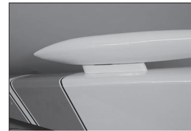
155. Den äußeren Abwurf-Pylon mit zwei M4 x 20 mm Innensechskantschrauben und zwei M4 Sicherungsscheiben an der Unterseite der Außentragfläche befestigen.
