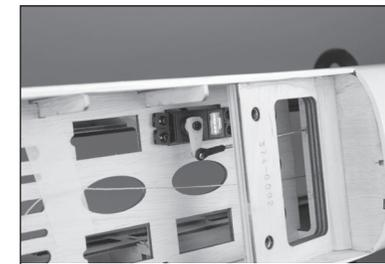
62. Eine Schnur an einer 1200 mm (48 Zoll) Verlängerung festbinden und beachten, dass das Schnurende zur Befestigung am Höhenruder-Servo erforderlich ist.
