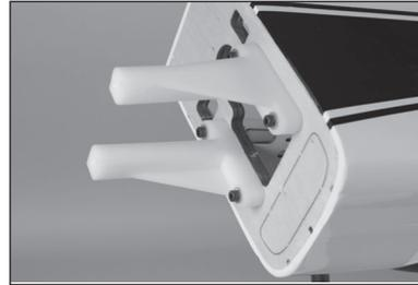
65. Das Mittelteil am Ausleger montieren und dafür die Passstifte im oberen Teil des Auslegers einpassen.
