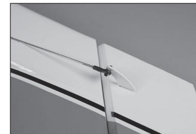
61. Den Servo im Ausleger montieren, wobei der Ausgang zur Vorderseite des Flugzeugs weist. Den Servoarm am Servo befestigen. Bei eingeschaltetem Funkgerät und zentriertem Seitenruder-Servo die Verbindung zur Mitte des Seitenruders ausrichten. Nach dem Zentrieren den Servoarm mit der dem Servo beiliegenden Hardware am Servo befestigen.
