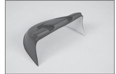
**126.** Die Haube probeweise im Cockpit einpassen. Nach Bedarf zuschneiden, damit sie gut sitzt. Die Haube mit Kontaktkleber in Position kleben.
