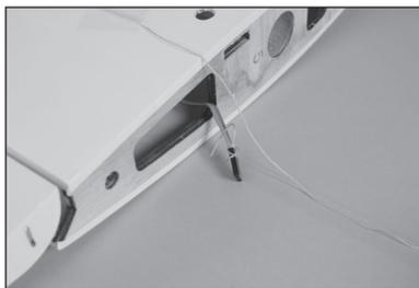
46. Das Servo in die Tragfläche einbauen und die Servoabdeckung mit M2,5 x 10 mm Blechschrauben befestigen. Darauf achten, dass die Gewinde im Holz vorbereitet und gehärtet sind, wie es für die Abdeckungen bei den Stabilisator-Servos beschrieben ist.
