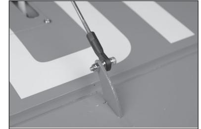
40. Den Gabelkopf am Servoarm anbringen. Bei eingeschaltetem Funkgerät und zentriertem Höhenruder-Servo das Gestänge zum Zentrieren des Höhenruders ausrichten. Nach dem Justieren den Silikonhalter über die Zinken des Gabelkopfs schieben.
