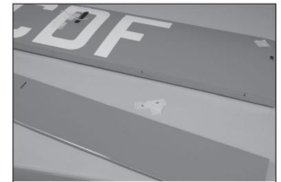
4. Mit einem Feilkloben oder Rotationswerkzeug und einem 1,5 mm (1/16 Zoll) Bohrer die zuvor gekennzeichnete mittige Position an der Hinterkante und an der Steuerfläche aufbohren.
