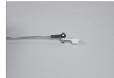
59. Beim Anbringen des Gabelkopfes am Servoarm das Loch im Arm verwenden, das 21 mm (13/16 Zoll) von der Mitte des Servohorns entfernt liegt. Dieses Loch muss mit einem Feilkloben und einem 2 mm (5/32 Zoll) Bohrer vergrößert werden.
