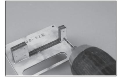
28. Eine Servohalterungsschraube in jedes Loch drehen und dann alle Schrauben entfernen.
