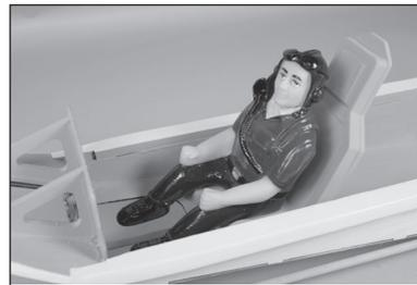
**123.** Eine kleine Menge Epoxyd auftragen, um die Beine des Piloten auf den Cockpit-Boden zu kleben. So wird verhindert, dass das Gewicht des Piloten den Sitz beschädigt.
