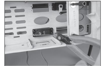
81. Das Gasgestängerohr auf 127 mm (5 Zoll) zuschneiden und das Rohr auf das Gestänge schieben.
