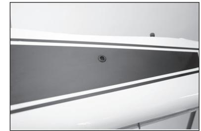
95. Einen Schalter für das Zündsystem an der Seite des Rumpfes anbringen. Sicherstellen, dass seine Positionierung den Betrieb der Seitenruder- und Gas-Servos nicht beeinträchtigen.
