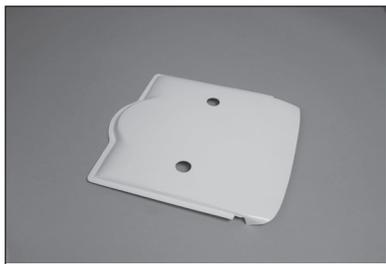
132. Die Rumpfabdeckung mit Kontaktkleber in Position kleben. Mit einem Klebeband mit geringer Klebekraft die Abdeckung in Position halten, bis der Kleber vollständig ausgehärtet ist.
