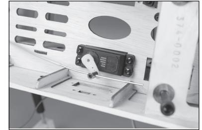
87. Nachdem die Ausführung überprüft wurde, die mit dem Servo gelieferte Hardware verwenden, um den Arm am Servo zu sichern.
