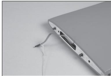
36. Höhenruder-Servo mit einem Nr. 1 Kreuzschlitzschraubendreher und vier M2,5 x 10 mm Blechschrauben befestigen.
