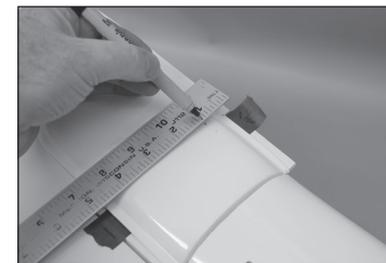
136. Die Abdeckung vom Mittelteil des Flügels entfernen. Mit einem 3 mm (1/8 Zoll) Bohrer Vorbohrungen für die Schrauben in der Abdeckung bohren.
