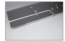
Durch versuchsweises Einpassen der Außentanks an den Tragflächenspitzen zu diesem Zeitpunkt ermöglicht die Installation des Querruders die Überprüfung, dass das Querruder nicht mit dem Außentank in Berührung kommt.
