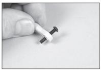
13. Den Bereich der Querruder-Steuerhörner dort leicht schleifen, wo sie ins Querruder eingepasst werden. (Die Querruder-Steuerhörner sind die längsten im Lieferumfang enthaltenen Hörner.)
