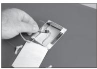
**33.** Den Servo mit den mitgelieferten Schrauben montieren. Den Servo zentrieren und den Servoarm senkrecht zur Mittellinie des Servos befestigen. Alle Arme entfernen, die den Betrieb des Servos beeinträchtigen werden.
