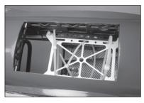
109. Den Anschlag im Tank einpassen und prüfen, ob sich das Pendel im Kraftstofftank frei bewegen kann. Bei Bedarf ausrichten. Den Anschlag mit der M3 x 25 Zylinderkopfschraube sichern. Die Schraube mit einem 2,5 mm Sechskant sichern.
