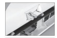
58. Die Klappe des Steuerhorns am flachen Bereich der Klappe mittig auf der im vorangehenden Schritt vorgenommenen Markierung positionieren. Das Klappensteuerhorn in Richtung der Unterseite der Klappe schieben, sodass der flache Teil des Steuerhorns zur Unterseite der Tragfläche zeigt. Die Position der Befestigungsschrauben der Klappe des Horns mit einem Filzstift markieren.
