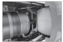
133. Das Seitenleitwerk in Position einpassen. Ein kleines Kunststoffteil in der Aufhängungsleitung und entlang der Unterseite des Seitenruders anbringen, um ein Ankleben des Seitenruders am Rumpf zu verhindern. Mit einem Papiertuch und Isopropylalkohol sämtliche Epoxidrückstände entfernen.
