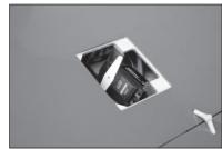
**53.** Die Servoleitung für Klappe und Querruder durch die Tragfläche bis zur Tragflächenwurzel führen.
