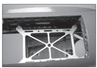
108. Mit einem Kabelbinder die Kraftstoffleitung am Pendel sichern.
