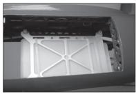
121. Die Servokabelführung hinten im Rumpf am Anbringungsort des Stabilisators lokalisieren. Die Schnur an zwei 1200 mm (48 Zoll) Verlängerungen festbinden. Sicherstellen, dass die Stecker mit dem Empfänger verbunden sind.
