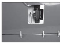
→ Beim Anschließen des Gabelkopfes am Servoarm das Loch im Arm verwenden, das 16 mm (5/8 Zoll) von der Mitte des Arms entfernt liegt.
