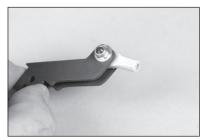
Die Steuerhornbasis auf den Boden der Steuerhornbaugruppe schieben.
