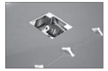
**61.** 2 bis 3 Tropfen dünnen CA-Klebstoff in jedes der Löcher auftragen. Der CA-Klebstoff muss vor dem Fortfahren vollständig ausgehärtet sein.
