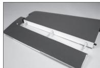
73. Beim Installieren der Aufhängungen des Seitenruders beachten, dass die untere Aufhängung verkürzt wurde, damit sie hinter in das Verbindungsrohr für das Seitenleitwerk passen.
