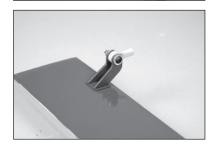
74. Verwenden Sie dieselbe Technik, wie für die Klappenaufhängung zur Sicherung der Aufhängungen des Seitenruders Mit einem Papiertuch und Isopropylalkohol sicherstellen, dass jeglicher überschüssige Klebstoff von den Aufhängungen entfernt wird. Das Seitenruder mit einem Klebeband mit geringer Klebekraft in Position halten, bis der Klebstoff vollständig ausgehärtet ist.
