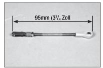
**45.** Den Kugelkopf am Steuerhorn befestigen und dann den Gabelkopf am Servoarm. Bei eingeschaltetem Funkgerät und zentriertem Querruder-Servo die Verbindung zur Mitte des Querruders ausrichten. Nach dem Justieren den Silikonhalter über die Zinken des Gabelkopfs schieben.
