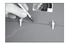
62. Die Klappe des Steuerhorns mit zwei M3 x 14-Blechschrauben und einem Nr. 1-Kreuzschlitzschraubendreher an der Klappe anbringen. Die Ausrichtung des Klappen-Steuerhorns beachten.
