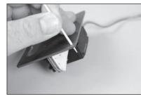
**34.** Beim Anschließen des Gabelkopfes am Servoarm das Loch im Arm verwenden, das 16 mm (5/8 Zoll) von der Mitte des Arms entfernt liegt.
