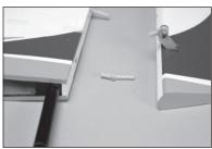
**69.** Das Steuerhorn für das Höhenruder mit den Techniken für das Querruder-Steuerhorn installieren.
