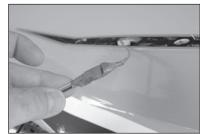
123. Die Servoführungsmanschetten so weit wie möglich nach hinten schieben. Die Manschetten an der Spritzwand markieren, damit die Positionierung vor jedem Flug überprüft werden kann. Die Manschetten mit Kabelbindern an der Struktur oberhalb der Position für das Schubrohr befestigen, damit sie während des Betriebs des Modells nicht mit dem Auspuffrohr in Berührung kommen.
