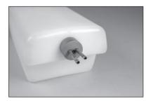
114. Den Kraftstofftank in den Rumpf schieben. Eine kleine Menge Silikonklebstoff zwischen Halterung und Tank anbringen, um zu verhindern, dass der Tank während des Flugs an der Halterung rutscht.
