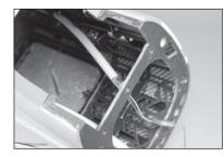
**116.** Den Tank mit Hilfe von Kabelbindern sichern. Überstehende Teile mit einem Seitenschneider abschneiden.
