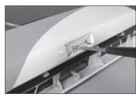
**65.** Den Verfahrweg auf dem Sender in die Klappenposition "UP" [Eingefahren] bewegen. Die Werte auf dem Sender so anpassen, dass die Hinterkante im Flügel ausgerichtet ist.
