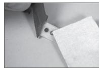
18. Eine M3 Unterlegscheibe auf die M3 x 15 Rundkopf-Maschinenschraube schieben. Die Schrauben in die Steuerhörner einpassen, dann das Kugelende auf die Schraube schieben.
