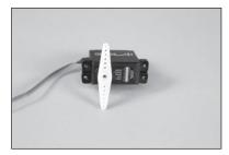
Den Klappen-Servo mit nach außen weisendem Ausgang installieren. Die mit dem Servo gelieferte Hardware verwenden.
