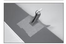
27. Sicherstellen, dass der Abstand der Aufhängung entlang der gesamten Länge des Querruders gleich ist. Das Querruder mit einem Klebeband mit geringer Klebekraft in Position halten, bis der Klebstoff vollständig ausgehärtet ist.
