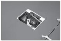
**55.** Das Gestänge so positionieren, dass es senkrecht zur Linie der Klappenaufhängung steht.
