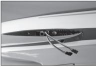
117. Die Abdeckung der Füll- und Entlüftungs-Fittings mit einem Hobbymesser und einer Nr. 11 Klinge entfernen. Fittings anbringen und die Leitungen vom Tank anschließen.
