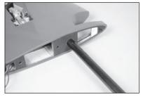
144. Das Rohr in die Lasche des Rumpfs schieben. Die Leitungen von Querruder und Klappe an den Verlängerungen anschließen. Die Leitungen von Einfahrvorrichtungen und Bremsen in den Rumpf führen.
