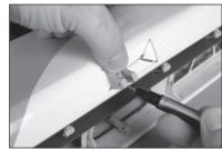
63. Die Kugelverbindung mit einer M3 x 15 Maschinenschraube und einer M3 Unterlegscheibe am Klappen-Steuerhorn befestigen Die Schraube mit einem 2mm Sechskant festziehen.
