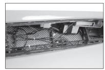
100. Einen zweiten Funkempfänger mit Klettband im Rumpf anbringen. Sicherstellen, dass die Antennen in verschiedene Richtungen ausgerichtet sind.
