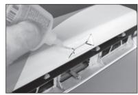
**66.** Den Verfahrweg auf dem Sender so einstellen, dass eine vollständige Klappenauslenkung von 70 mm (2³/4 Zoll) erreicht wird.
