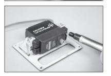
**30.** Den Servo entfernen und mit einem 1,5 mm (1/16 Zoll) Stiftschraubstock vier Löcher für die Servohalterung bohren.
