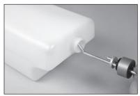
105. Mit Lötkolben und Lot einen Bereich an jedem Ende der Rohrleitungen bilden (beide nach außen und ungebogenes Rohr im Tank) damit das Kraftstoffrohr an den Rohrleitungen gesichert werden kann.
