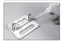
Die Abdeckung für den Klappen-Servo entfernen. Mit der Schnur die Servoverlängerung zur Öffnung für den Klappen-Servo ziehen.
