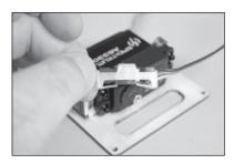
31. Eine Servohalterungsschraube in jedes Loch drehen und dann die Schrauben entfernen.
