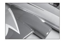
**146.** Mit den zwei 1/4-20 x 2-Zoll Nylonschrauben den Flügel am Rumpf sichern.
