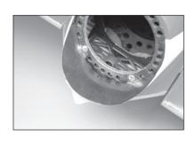
**125.** Das Auspuffrohr von der Vorderseite des Rumpfs ausgehend hinten am Rumpf einschieben .
