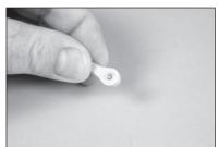
47. Eine M3 x 15 Rundkopf-Maschinenschraube in die Kugel schieben. Es kann nötig sein, eine kleine runde Feile zu benutzen, um Grate aus der Aluminiumkugel zu entfernen. Vier Kugelköpfe vorbereiten.
