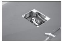
70. Verwenden Sie dieselbe Technik, wie für die Klappenaufhängung zur Sicherung der Aufhängungen des Höhenruders Mit einem Papiertuch und Isopropylalkohol sicherstellen, dass jeglicher überschüssige Klebstoff von den Aufhängungen entfernt wird. Das Höhenruder mit einem Klebeband mit geringer Klebekraft in Position halten, bis der Klebstoff vollständig ausgehärtet ist.
