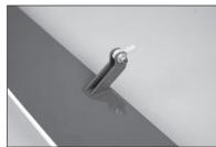
26. Die Querruder mit der gleichen Technik wie für die Aufhängungen der Klappe angegeben einhängen. Sicherstellen, dass das Querruder mit der Rückplatte ausgerichtet ist.
