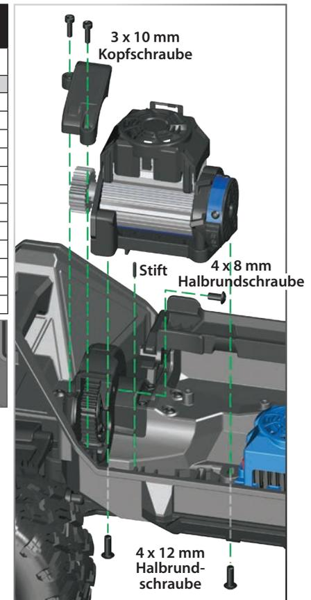
Sie den Motor mit den zwei von der Unterseite des Chassis eingeführten 4x12-mm-Halbrundkopfschrauben in Position und dann mit der 4x8-mm-Halbrundkopfschraube in der Motorplatte.
