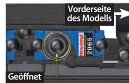
**Differential gesperrt:** Schalten Sie den Sender und den Empfänger ein. Bringen Sie den T-Lock Schalter in die mittlere Position, um das vordere Differential zu sperren. Vergewissern Sie sich, dass sich die Ausgangswelle der Servos gegen den Uhrzeigersinn dreht, um das Servohorn in die gezeigte Position zu drehen.
