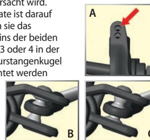
Wenn Sie eine andere Kombination von Spurstangenaufnahmepunkten verwenden, sollte die Spurstangenkugel mit dem großen flachen Ende unten (C) ausgerichtet werden.
