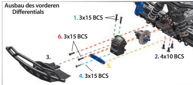
6. Entfernen Sie die zwei 3 x 15 mm Schrauben vom Differentialgehäuse und ziehen Sie die beiden Gehäusehälften vorsichtig auseinander. Entfernen Sie nicht die beiden Schrauben, die den Stoßdämpfer sichern.
