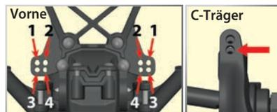
Um das Rollzentrum noch niedriger einzustellen, verschieben Sie die äußeren Spurstangenenden auf die untere Position am C-Träger.
