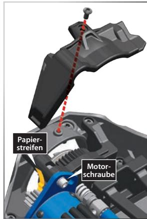
Zur Einstellung des Zahneingriffs lösen Sie die Motorschraube. Schneiden Sie einen dünnen Streifen Papier ab und legen Sie es zwischen die Zahnräder. Schieben Sie den Motor nach vorne, damit das Ritzel in das Zahnrad eingreift. Ziehen Sie die Schrauben des Motors fest und entfernen Sie den Streifen Papier. Der Papierstreifen sollte durch die Zahnräder bewegt werden können, ohne dass er klemmt.
