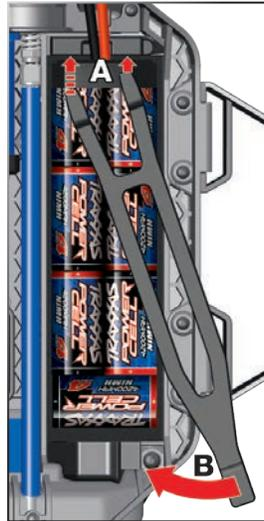
Setzen Sie die Batterie mit den Kabeln zur Rückseite des Modells ein. Führen Sie die Laschen der Batterie in die Schlitzlöcher der Batteriehalterung ein (A). Drehen Sie die Batteriehalterung in Richtung des Chassis' und rasten (festklemmen) Sie das Ende in den vorderen Haltebügel (B).
