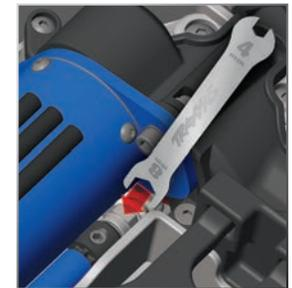
Platzieren Sie das Modell auf einem Untergrund mit hoher Traktion, z. B. einem Teppich. Stellen Sie die Rutschkupplung so ein, dass Sie sie ungefähr 60 cm (zwei Fuß) hören, wenn Sie aus dem Stand voll beschleunigen. (Lesen Sie mehr über die Rutschkupplung in der Leiste an der Seite.)
