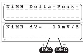
La tensione di riferimento (in mV per cella!) dello spegnimento automatico per gli accumulatori NiMH può essere impostata. Gli accumulatori NiMH tuttavia hanno una caduta di tensione inferiore agli accumulatori NiCd. Si sono rivelati accettabili valori di impostazione della tensione di 5 ... 25 mV/cella. Tensioni superiori provocano rapidamente una sovraccarica dell'accumulatore, tensioni inferiori provocano spesso un'interruzione anticipata.
