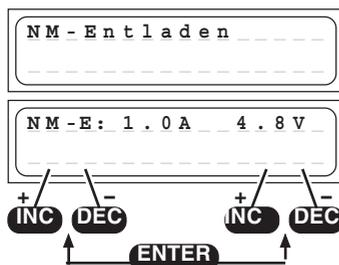
Questo programma è utile per es. per determinare la capacità residua oppure per la scarica dell'accumulatore di una trasmittente, di una ricevente o di alimentazione di un motore. Con questo programma viene effettuata la scarica con una corrente di scarica impostata (0.1 ... 1.0 A, a sinistra sul display) fino alla tensione finale di scarica (0.1 ... 16.8 V, a destra sul display).
