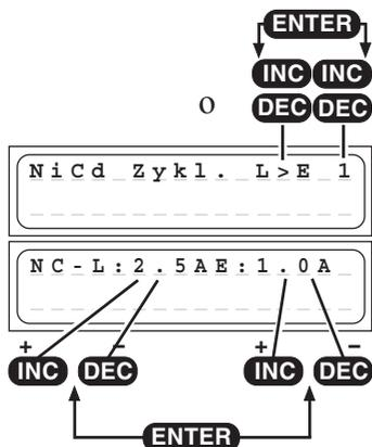
Questo programma serve per ottimizzare la capacità e la formattazione di un accumulatore. In alto a destra sul display impostate, con i tasti INC / DEC se il programma di formattazione deve iniziare con la carica o la scarica. Quindi impostate il numero di cicli da 1 a 5 (per es. impostando 3 cicli, l'accumulatore viene caricato e scaricato tre volte).
