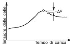
Lo spegnimento automatico del processo di carica (riconoscimento di accumulatore completamente carico) funziona secondo il principio del delta peak, già provato milioni di volte e noto anche come delta-U o delta-V. In questo procedimento viene valutata la tensione massima della curva di carica, che indica con molta precisione la massima carica immagazzinata. Onde evitare di sovraccaricare l'accumulatore vi consigliamo di iniziare con una tensione di spegnimento Delta-Peak di 10mV.
