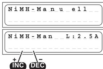
Con questo programma l'accumulatore viene caricato con la corrente di carica impostata. La corrente di carica massima può essere impostata con i tasti INC / DEC da 0.1 A a 5.0 A **prima** di collegare l'accumulatore. Il processo di carica termina in accordo con i valori impostati per la tensione di spegnimento del delta peak.
