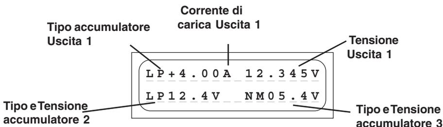
I dati essenziali relativi alla carica e scarica vengono visualizzati chiaramente sulle due righe del display a cristalli liquidi e sono mantenuti fino allo scollegamento dell'accumulatore. Quando viene collegato un altro accumulatore i valori precedenti non sono più richiamabili.
