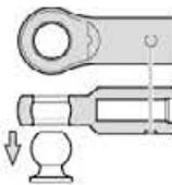
★取り付けには向きがあります。○印側をボールに押し込みます。
