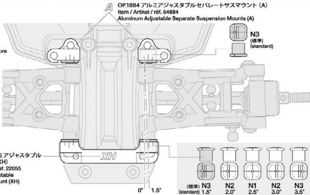
★右表はXV-02サスマウントとセパレートサスマウントの組み合わせによるトー角の変化を表しています。
