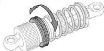
★スプリングアジャスターを回してスプリングの硬さ、車高を調整します。
