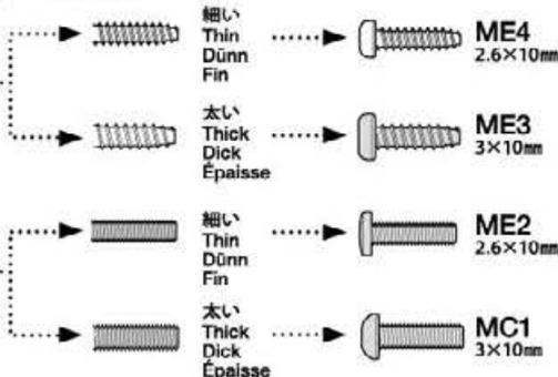
★使用するサーボの取り付け部に合わせて選びます。
