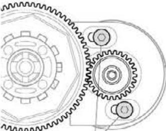
★ギヤが軽くなるようにスキ間を調節してモーターを固定してください。
