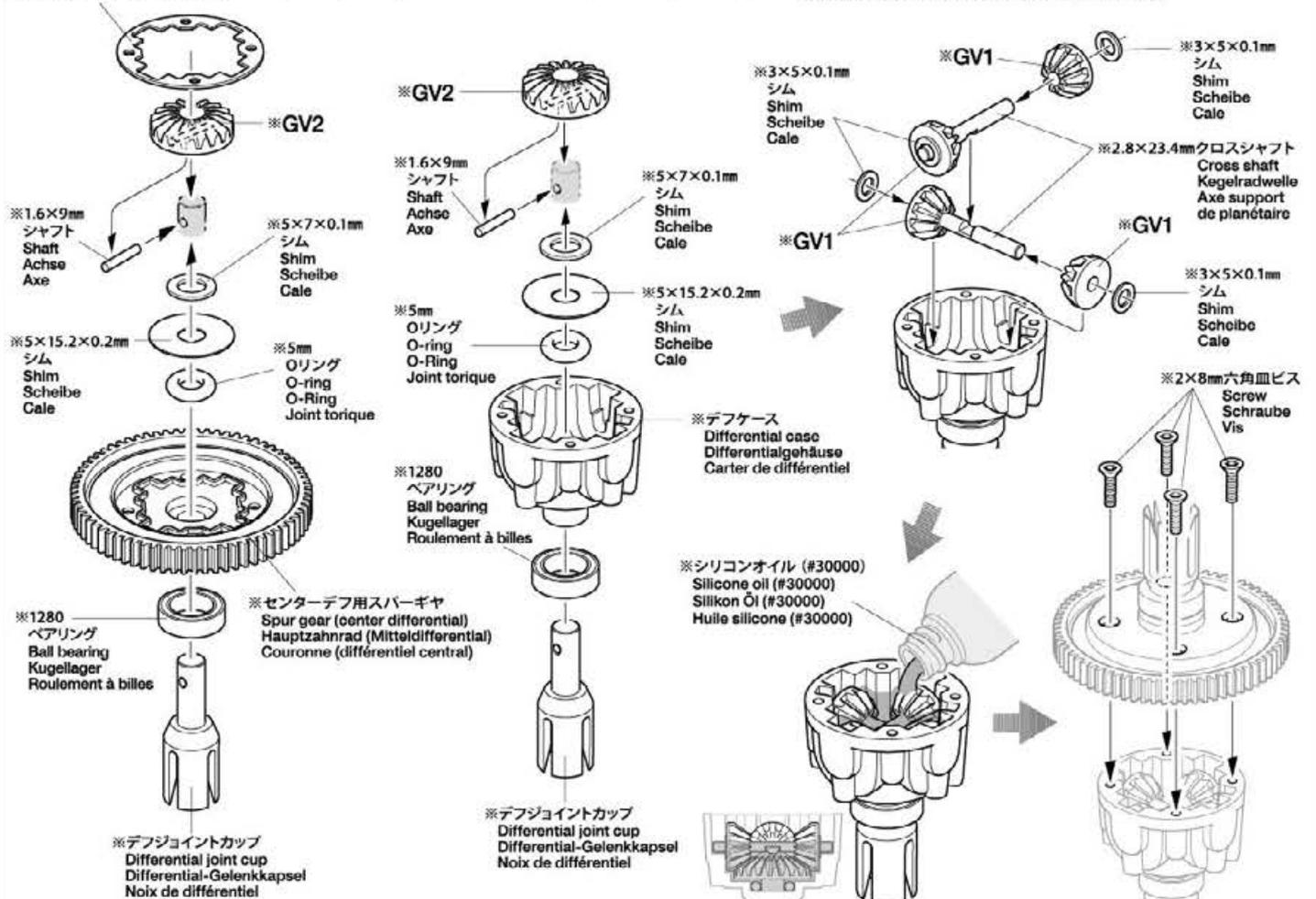
★左記の部品を組み合わせ、スパークギヤをセンターデフとして機能させます。前後輪の回転差を吸収して旋回性能をさらに高めます。
