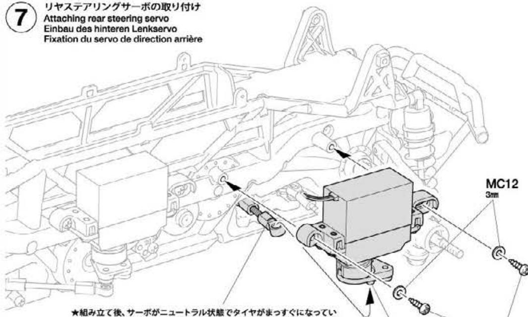
★組み立て後、サーボがニュートラル状態でタイヤがまっすぐになっていない場合、まっすぐになるように前後のステアリングロッドの長さを調整します。
