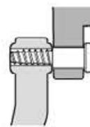
★段付ビス (MB1) は、アッパーアーム (N6) の動きがたかたならないようにネジ込みすぎに注意してください。
