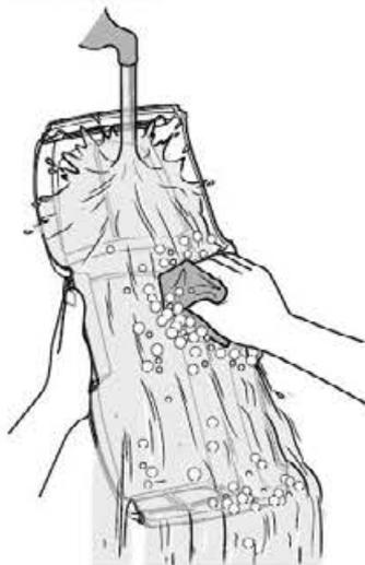
★塗装前に中性洗剤で油気をおとします。水洗いをして洗剤分を洗い流して乾かしてください。
