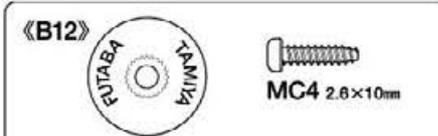
★タミヤ製サーボの場合はB12とMC4を使用します。他社製サーボを使用する場合は下の表をご覧ください。
