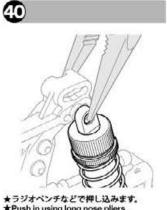
★ラジオペンチなどで押し込みます。 ★Push in using long nose pliers. ★Mit Spitzzange eindrücken. ★Enchasser à l'aide de pinces à becs longs.
