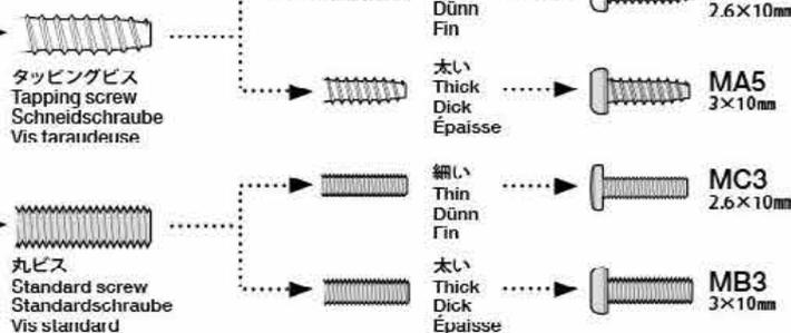
★使用するサーボの取り付け部に合わせて選びます。
