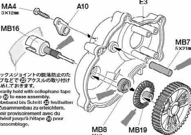
★ギヤボックスジョイントの脱落防止のためにテープなどで②アキスルの取り付けまで仮止めしておきます。
