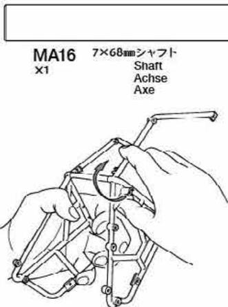
★ロールケージは図のように回転させて左右をねじ込みます。
