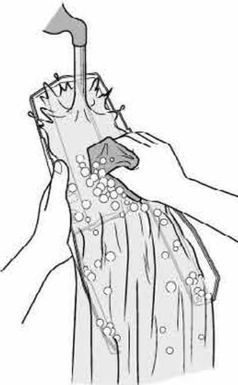
★塗装前に中性洗剤で油気をおとします。水洗いをして洗剤分を洗い流して乾かしてください。
