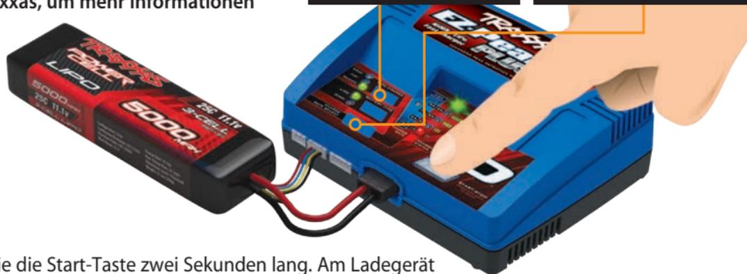
Drücken und halten Sie die Start-Taste zwei Sekunden lang. Am Ladegerät ertönt ein Signal, um anzuzeigen, dass der Ladevorgang begonnen wurde. Drücken Sie sie einmal, um zu stoppen. Das Ladegerät gibt einen Signalton ab, um zu signalisieren, dass der Ladevorgang abgebrochen wurde. Die Ladestatus-LED leuchtet, so lange die Batterie aufgeladen wird.
