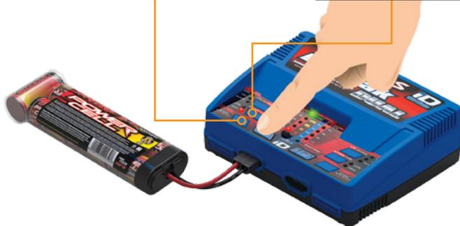
Drücken und halten Sie die Start-Taste(n) eine Sekunde lang. Das Ladegerät gibt einen Signalton ab, um zu signalisieren, dass der Ladevorgang begonnen hat. Drücken Sie einmal, um zu stoppen. Das Ladegerät gibt einen Signalton ab, um zu signalisieren, dass der Ladevorgang abgebrochen wurde. Die Ladestatus-LED leuchtet, so lange die Batterie aufgeladen wird.
