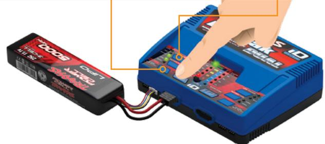
Drücken und halten Sie die Start-Taste(n) eine Sekunde lang. Das Ladegerät gibt einen Signalton ab, um zu signalisieren, dass der Ladevorgang begonnen hat. Drücken Sie einmal, um zu stoppen. Das Ladegerät gibt einen Signalton ab, um zu signalisieren, dass der Ladevorgang abgebrochen wurde. Die Ladestatus-LED leuchtet, so lange die Batterie aufgeladen wird.
