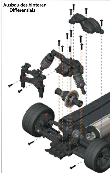
7. Zum Einbauen des Differentials befolgen Sie die Schritte in umgekehrter Reihenfolge.
