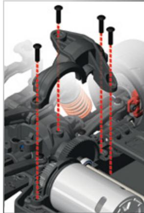
Um den Zahneingriff einzustellen, identifizieren Sie anhand der Tabelle links die Schraubenpositionen an der Motorplatte (A – K), die der gewählten Größe des Motorritzels (19-T – 29-T) entsprechen. Lösen Sie die beiden Schrauben vom Motor/von der Motorplatte und setzen Sie sie an den entsprechenden Positionen wieder ein; setzen Sie den Motor/die Motorplatte wieder in das Chassis ein.
