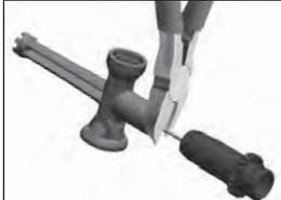
c. Entfernen/Montieren des Stabendes
