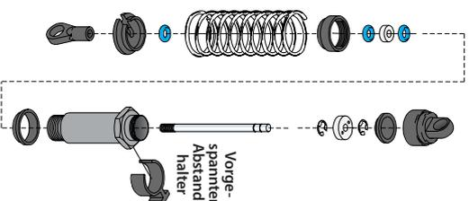
Die Aufhängung Ihres Modells kann verändert werden, damit Sie auf einer ganzen Reihe unterschiedlicher Untergründe mit voller Leistung fahren können. Mit einfachen Änderungen an den Stoßdämpferpositionen, können Sie das Handling des Fahrzeugs verändern.
