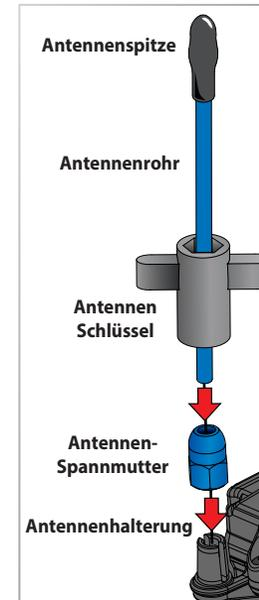
**!** Um einen Verlust des Funksignals oder eine Reduzierung der Reichweite zu vermeiden, bitte das schwarze Kabel nicht schneiden oder knicken, die Metallspitze nicht biegen oder abschneiden und das weiße Kabel am Ende der Metallspitze nicht biegen oder abschneiden.
