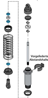
über der Parallele zum Boden befinden. Beobachten Sie, wie sich das Modell in Kurven verhält. Die richtige Einstellung wird das Modell stabilisieren und Spin-Outs verhindern. Experimentieren Sie mit unterschiedlichen Federn und Stoßdämpferölen, um herauszufinden, was für Ihren Streckenbedingungen am besten funktioniert.
