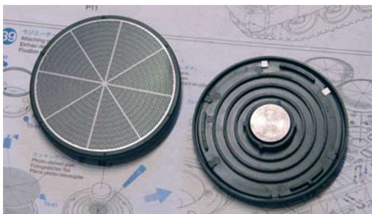
Die größeren Kühlergrills werden mit Magneten auf der Wanne gehalten. So gelangt man schnell an den Innenraum, um das Wannenteil besser verschrauben zu können
