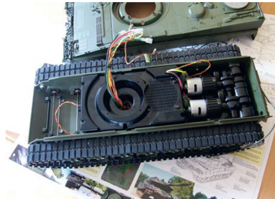
Die Kabel der Lautsprechereinheit führen in den Turm, wo beim Leo-Modell auch der Akku untergebracht ist
