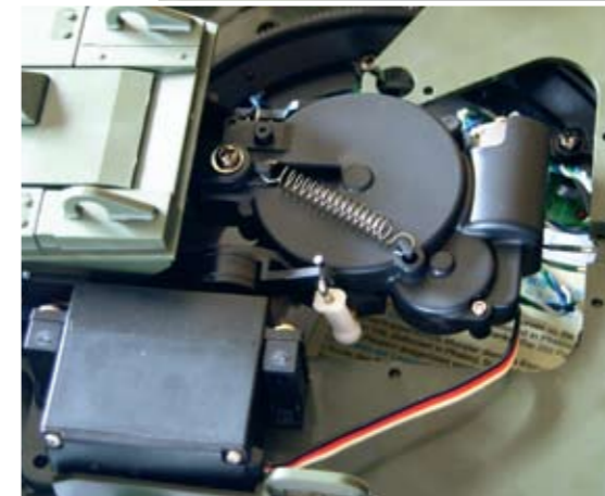
Die Rückstoßeinheit der Kanone. Unten links befindet sich das Servo zur Verstellung des Kanonenrohrs
