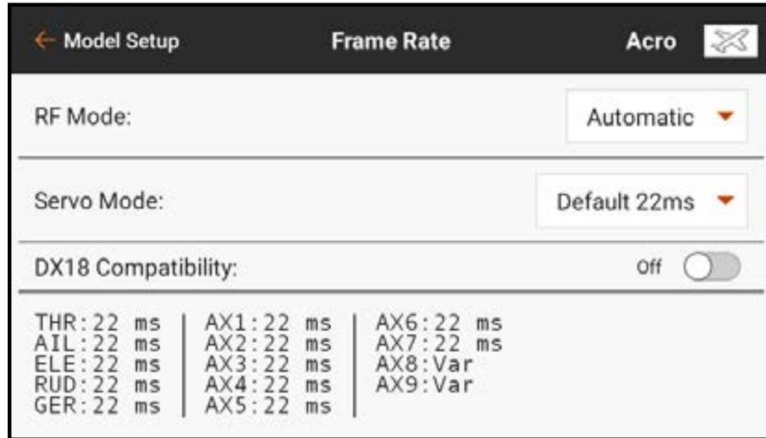
**Mode de servo** : les options sont Default 22ms (22 ms par défaut), Hybrid 11/22ms (Hybride 11/22 ms), 12@22 X+ ou 14@22ms.
