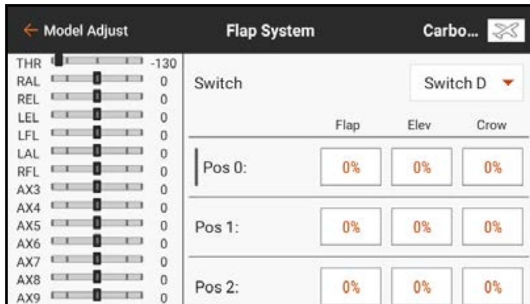
4. Wenn erforderlich, eine etwaig erforderliche Höhenruder-Mischung für jede Schalterposition durch Antippen des Wertefelds **Elev** [**Höhenruder**] und Schieben des Kreises an der Leiste entlang hinzufügen. Diese vordefinierte Mischung gleicht Pitchänderungen aus, die beim Einsatz der Klappen auftreten. Der Höhenruderausgleich sollte so eingestellt sein, dass das Modell einen horizontalen Flug in jeder Klappenposition aufrechterhält. Zum Speichern des Werts auf **OK** tippen.
