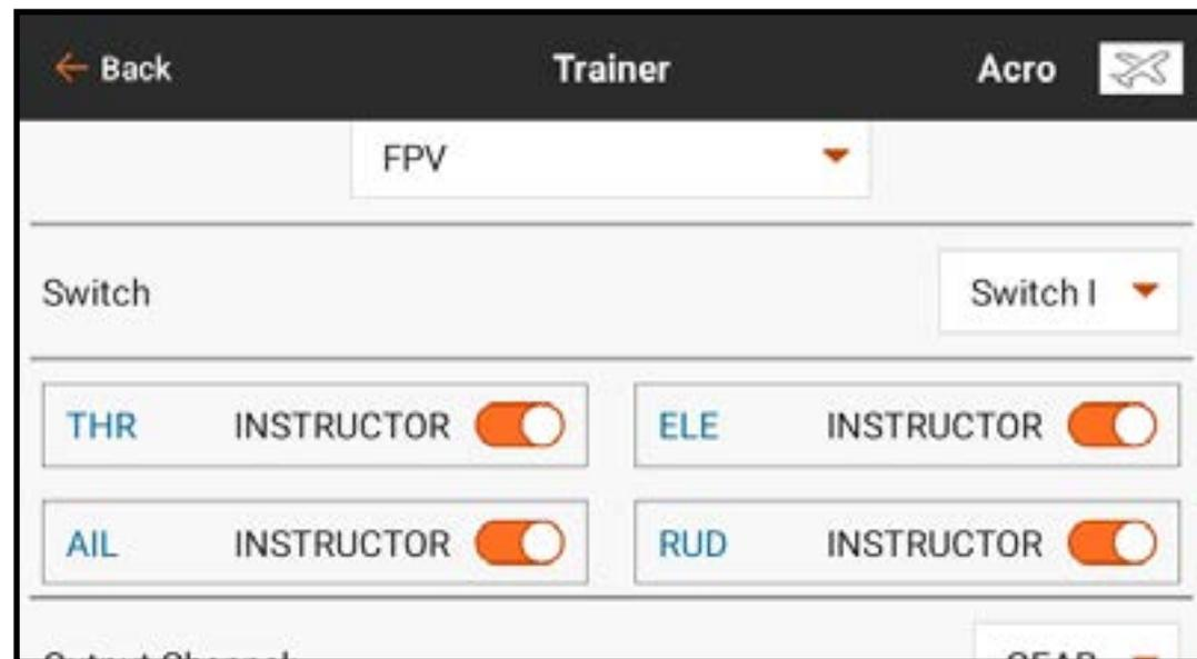
**Wireless FPV-Modus:** Die Nutzung eines Spektrum Focal-Headsets mit Hacktracking oder einem anderen DSMX- bzw. DSM2-Sender zur Steuerung des in der Luft befindlichen Kamera-Gimbal nutzen, ohne dass dieser mit einem Kabel an den iX14+ angeschlossen wird. Wireless FPV Modi sind mit jedem Spektrum DSMX- oder DSM2-Sender und Spektrum Focal Headsets kompatibel
