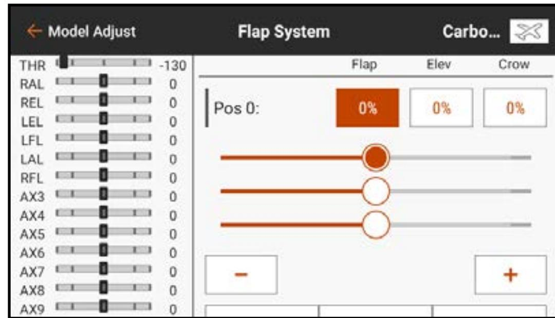
5. Die Klappengeschwindigkeit anpassen, um die Klappenbewegung für einen stärker den realen Bedingungen entsprechenden Betrieb oder einen schnellen Wechsel der Flugeigenschaften beim Einsatz der Klappen zu verlangsamen. Der Optionsbereich für die Klappengeschwindigkeit liegt zwischen
