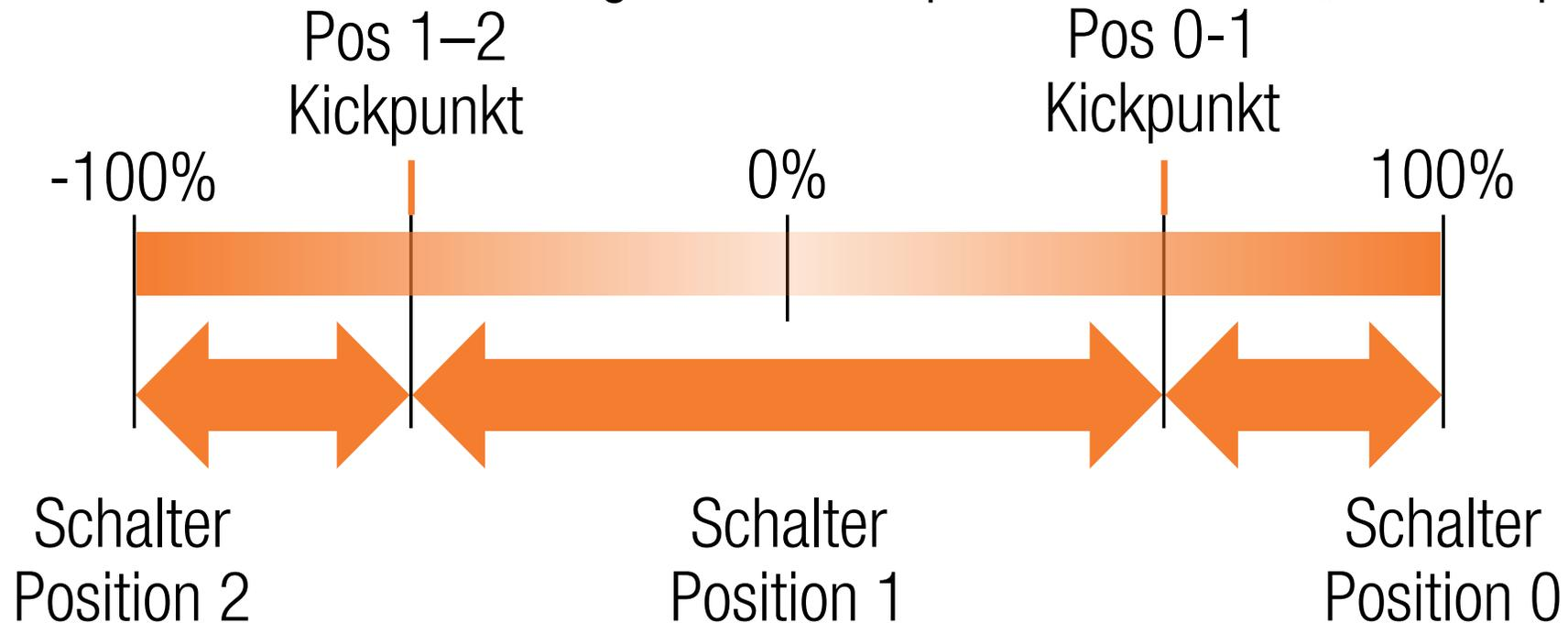
Im Standardzustand liegt der Kickpunkt für den Übergang zwischen den Positionen 0 und 1 bei 75 %. Der Kickpunkt für den Übergang zwischen den Positionen 1 und 2 liegt bei -75 Prozent. Die Eingabe liegt in Schalterposition 1 bei neutral (0%). Das Verschieben der Eingabe auf über 75 % ändert dies auf Position 0 und das Verschieben unter -75 % ändert es auf Position 2.
