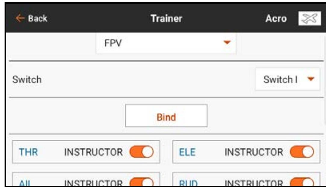
Jeder einzelne Ausgangskanal kann vom Trainersignal aus jedem beliebigen Eingangskanal zugeordnet werden, wobei alle anderen Steuerungen auf dem Ausbildersender verbleiben. Die primären Flugsteuerungskanäle werden standardmäßig durch den Ausbilder gesteuert. Alle Kanäle, mit den als Ausbilder eingestellten Flugsteuerungen verbunden sind, als diese belassen, wenn ein Headtracker verwendet wird.
