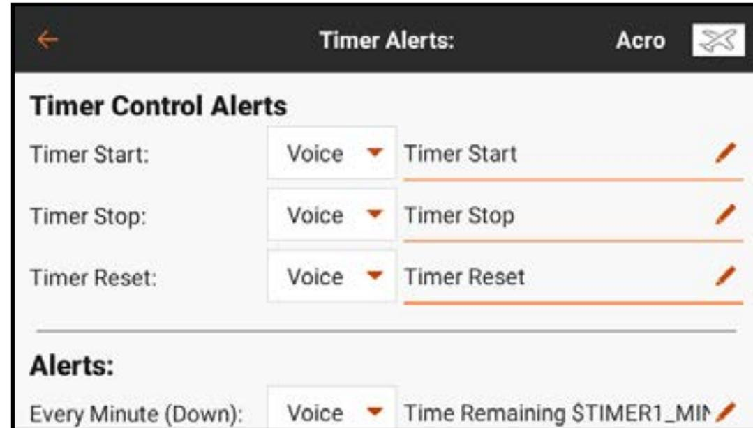
**TIPP:** Eines der Uhrensymbole ( 🕒 ) in der Timeranzeige auf dem Dashboard antippen, um direkt ins Timermenü zu gelangen. Die Timeranzeige im Dashboard gedrückt halten, um den Timer zurückzusetzen.
