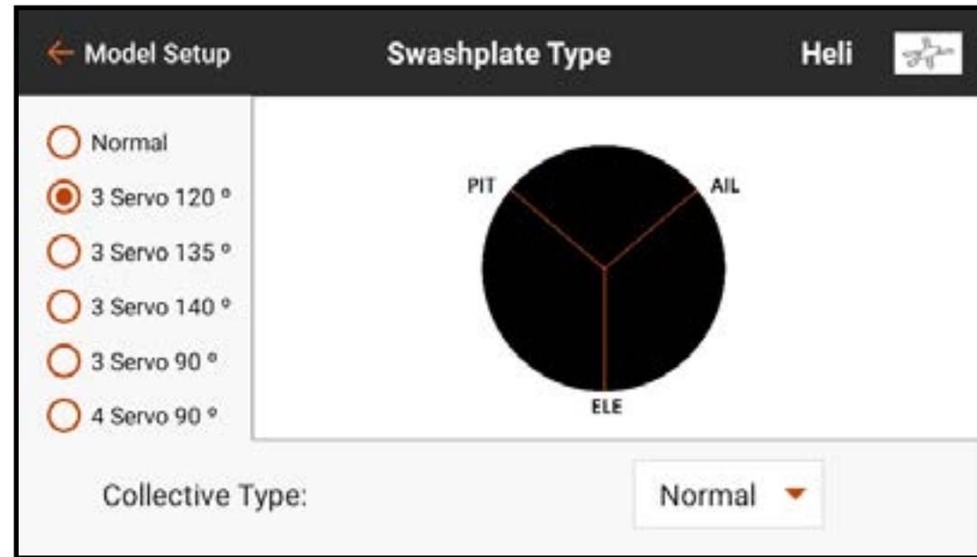
6. Taumelscheibe für jede Steuereingabe zu gewährleisten. Bei diesem Schritt muss die Taumelscheibe nicht die richtige Richtung reagieren, aber es ist wichtig, dass sie sich in der korrekten Weise mit Pitch und Roll neigt sowie sich mit Pitch hoch und runter bewegt.
