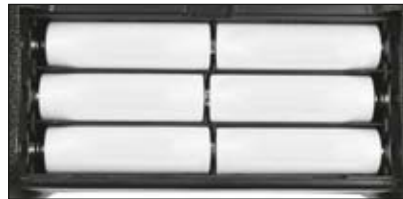
2. 6 x 1,5 V AA-Batterien einlegen und auf die Polaritätsangaben, wie im Batteriefach angegeben, achten.
