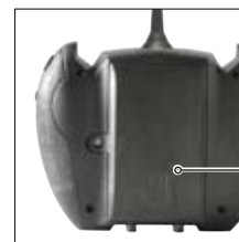
Cobertura da cavidade das pilhas
