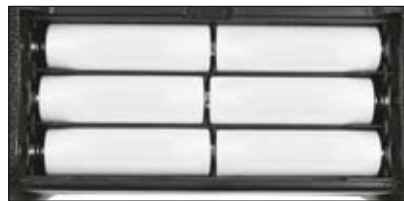
2. Colocar 6 x pilhas AA de 1,5 V e prestar atenção à posição correcta dos pólos indicada na cavidade das pilhas.
