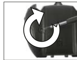
3. Fechar a tampa da cavidade das pilhas e aparafusá-la.
